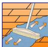
Zementschleier und Reste von zementär gebundenem Fugenmörtel müssen von der Oberfläche entfernt werden. Dazu wischt man den Belag einmal mit Lithofin KF Sanitärreiniger, ca.1:20 verdünnt. Danach nochmals mit klarem Wasser nachreinigen.
